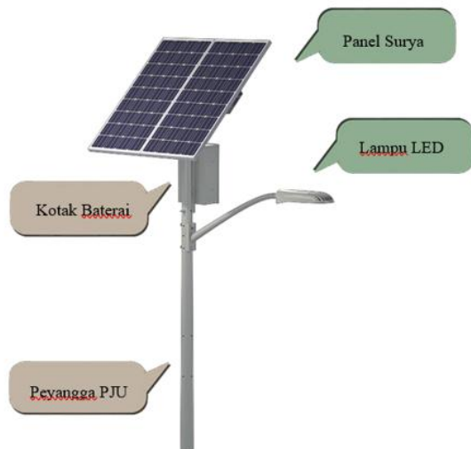
Gambar 1. Rancangan Penerangan Jalan Umum Tenaga Surya (PJUTS)
